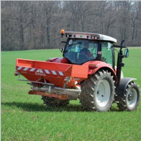
AXIS 20.1 Arbeitsbreite 12 – 28 m Max. Nutzlast 2100 kg
