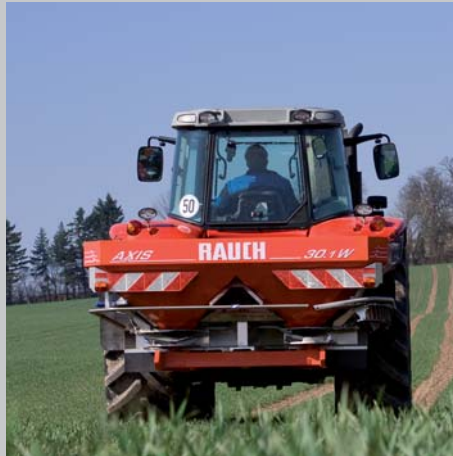
AXIS 30.1 Arbeitsbreite 12 – 42 m Max. Nutzlast 3000 kg
