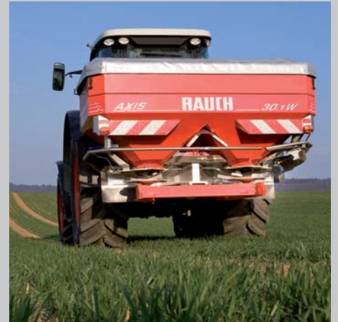
AXIS 30.1 W Wiegestreuer Arbeitsbreite 12 – 42 m Max. Nutzlast 3000 kg
